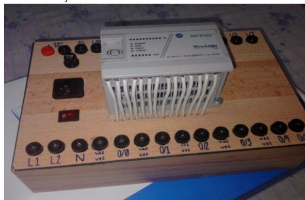
Se realizaron pruebas de conexión eléctrica donde se emplearon dos elementos de entrada PB1, PB4 y un elemento de salida bobina CON1; en la figura 5 se muestra el diagrama eléctrico de contactos que da solución al problema propuesto: realizar un programa para el arranque y paro de un motor de fase partida que al oprimir PB1 el motor se energice girando en una dirección y al oprimir PB2 se detenga.
